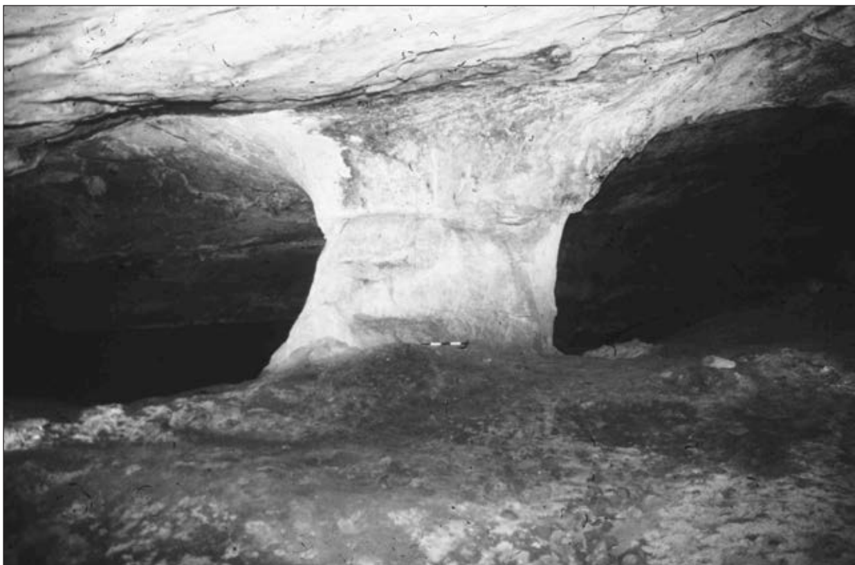
Figure n° 33 : Largentière (Ardèche) : exploitation par chambre et pilier résiduel (cliché M.-C. Bailly-Maître)
